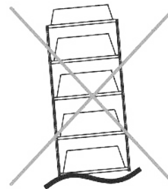
Не ровный пол. Эксплуатация запрещена.
